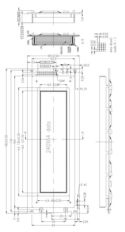
REMARKS: 1,UNMARKED TOLERANCE IS ±0.20 2,MATERIAL COMPLY WITH THE ROHS.
